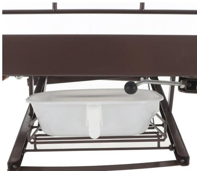
Б) При необходимости отрегулируйте ход туалетной секции: извлеките шплинт на конце тяги туалетной секции, выведите тягу из зацепления с пластиной поворотной трубы и вкручивайте или выкручивайте её для регулировки плотного закрытия туалетной секции. Добившись нужного положения, снова вставьте конец тяги в отверстие пластины поворотной трубы и зашплинтуйте его.
