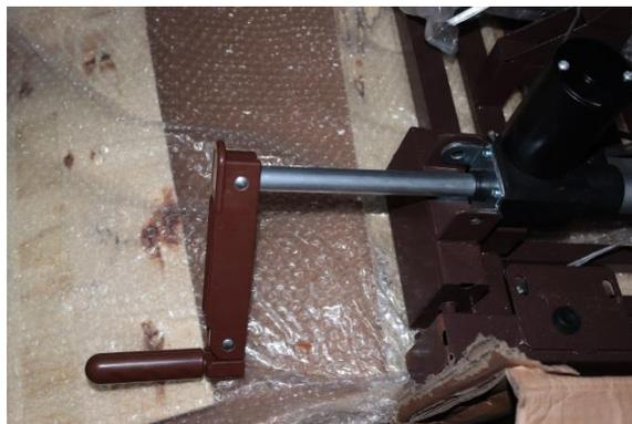
2. Вращайте ручку гибридного привода против или по часовой стрелки до тех пор, пока отверстия в кронштейне линейного актуатора не совместятся с отверстиями в кронштейне крепления актуатора на раме кровати. Соедините кронштейны болтами с гайкой. Верните заглушку линейного актуатора на место.
