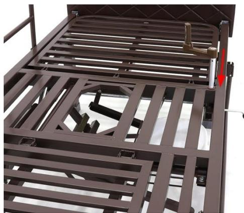
3.4. На случай отключения электропитания кровать модели YG-2 оснащена гибридными приводами. Для использования привода в ручном режиме отключите электропитание от сети. Снимите пластиковую заглушку на торцевой части линейного актуатора, вставьте в отверстие актуатора ручку гибридного привода и вращайте ее по часовой или против часовой стрелки до достижения нужного пациенту положения.
