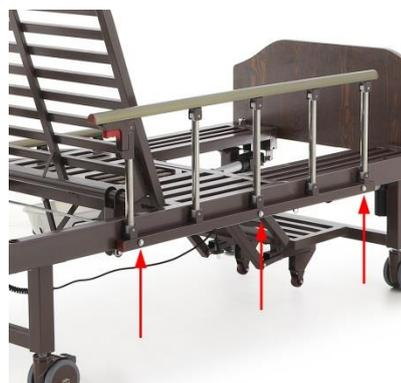
2.5.2 Закрепите крепления для боковых ограждений (опция) для кровати E-49 к раме кровати имеющимися болтами с гайками крепления как показано на рисунке.
