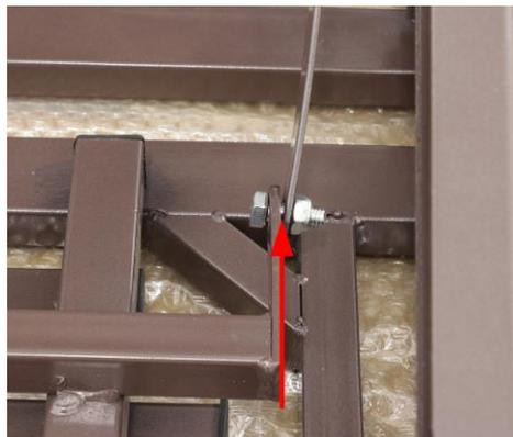
4. Закрепите поперечную тягу к ползьям. Служит для крайнего положения при открывании.
