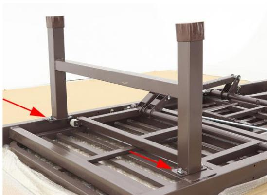
2.1.3 Для моделей YG-6 и YG-2 с колёсами: вкрутите оси колёс в соответствующие резьбовые отверстия ножных опор. Чтобы колесо при вкручивании не проворачивалось, заблокируйте его, нажав на рычаг тормоза. Вкрутите колесо до упора, не прилагая больших усилий, после чего обязательно надёжно затяните гайку на оси ключом (ключ в комплект не входит).
